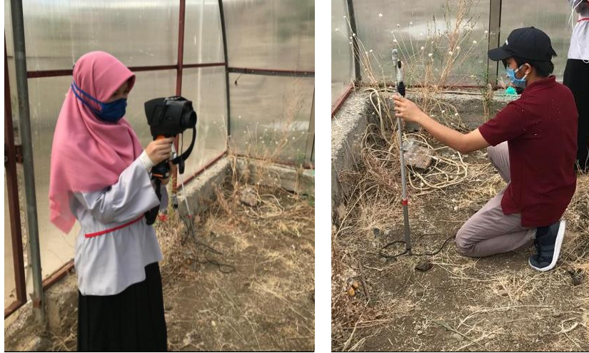
Şekil 3.7. termal kamera, termometre ve anemometre kullanarak veri toplama
