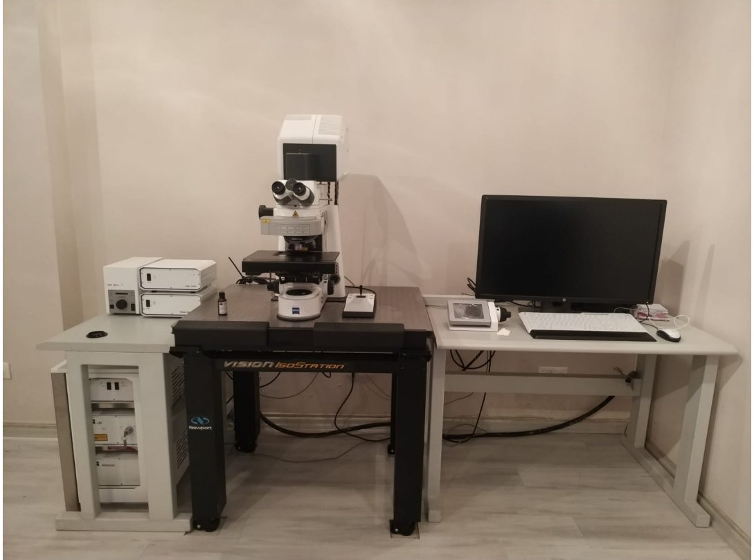
Şekil 3.7. Floresan ataçmanlı lazer taramalı konfokal mikroskop (Zeiss LSM 800, Almanya), ARUMLAB, Eskişehir Osmangazi Üniversitesi, Eskişehir
