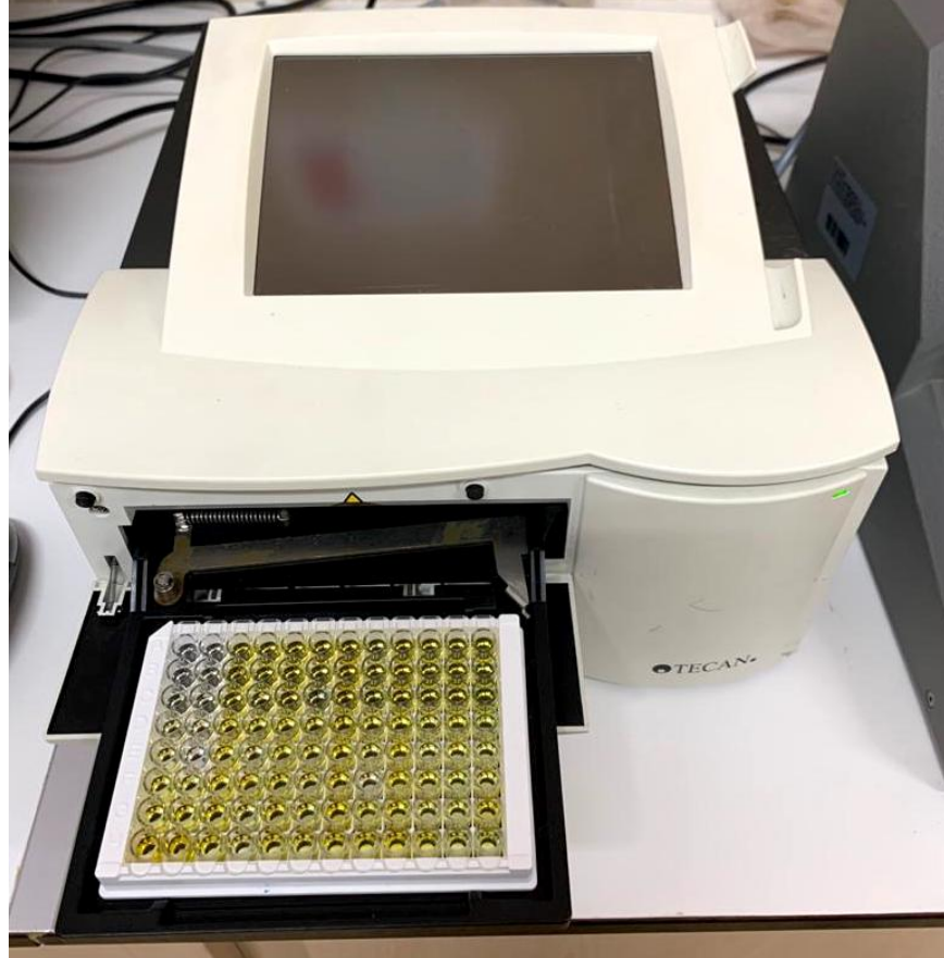
Şekil 3.4. 450 nm’de spektrofotometrik analize hazır mikrolaka ve mikrolaka okuyucu cihazı (Sunrise, Tecan Trading Ag, Mannedorf, Switzerland), Tıbbi Biyokimya Anabilim Dalı, Ondokuz Mayıs Üniversitesi
