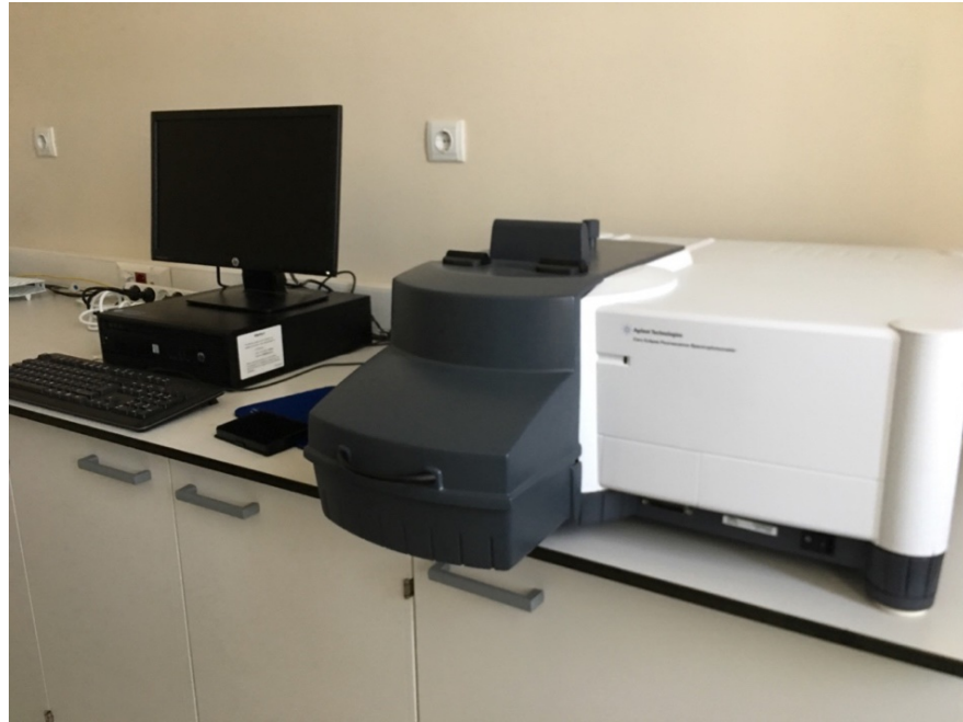
Şekil 3.6. Floresan spektrofotometrik analizlerin gerçekleştirildiği cihaz (Cary Eclipse, Agilent Technologies, Japonya), DAYTAM, Atatürk Üniversitesi, Erzurum
