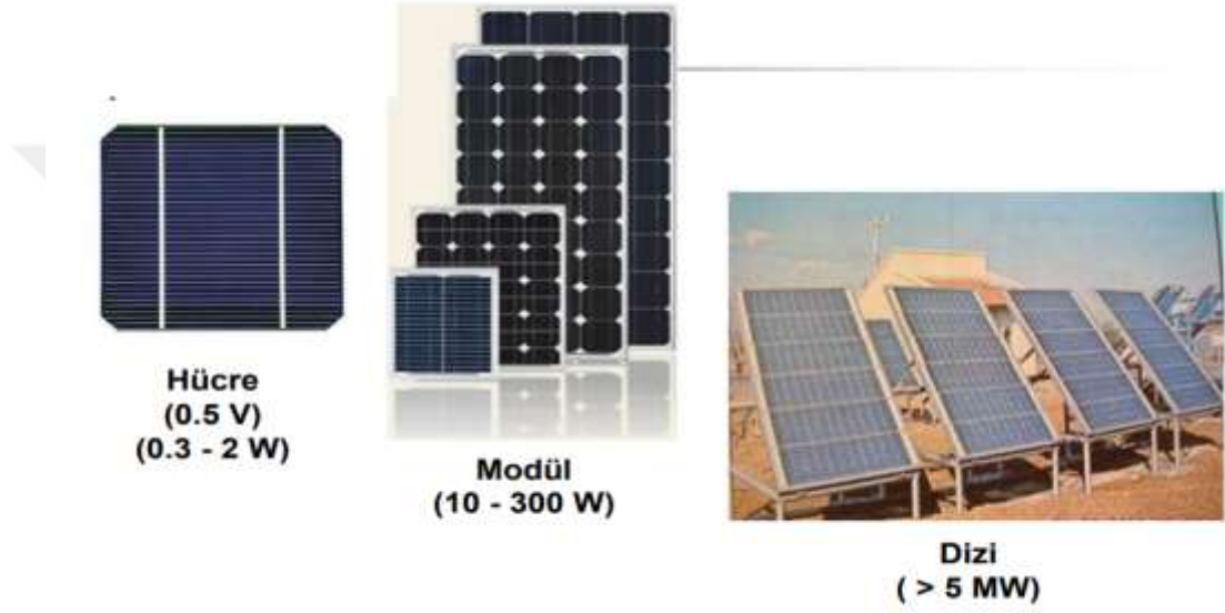
Şekil 2.23. Fotovoltaik hücre, modülü ve dizisi (Kıncay, Bekiroğlu, & Yumurtacı)
