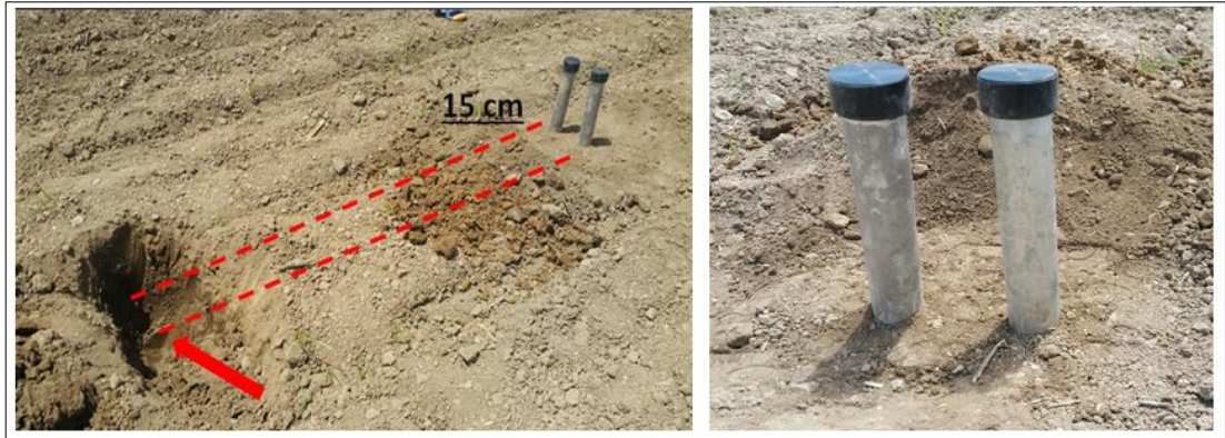
Şekil 3.7. Deneme parsellerinde nötron tüplerinin konumu
