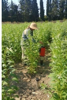
Nötron metre ile ölçüm aşaması
