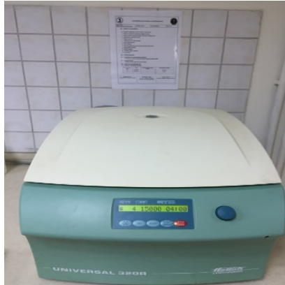
Şekil 3.6. 15000\text{ rpm} 'de 4^{\circ}\text{C} 'de 10 dakika santrifüj edilme (Hettich Universal 320R, Almanya) işlemi
