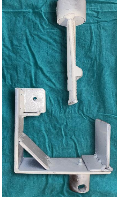
Şekil 3.16. Çalışmada kullanılan fiksasyon aparatı
