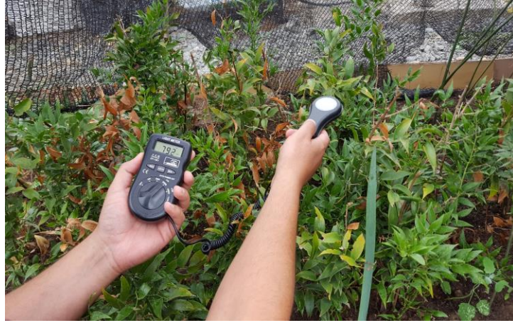
Şekil 3.4. Işık şiddeti ölçümü
