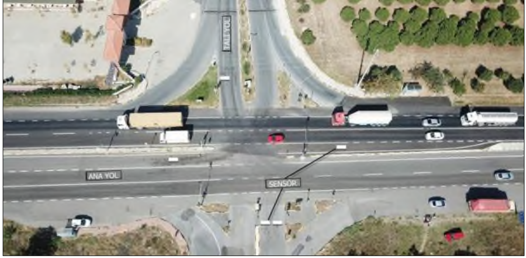
Şekil 3.11. Yarı Trafik Uyarmalı Sinyalizasyon Sistemi (KGM, 2019)
