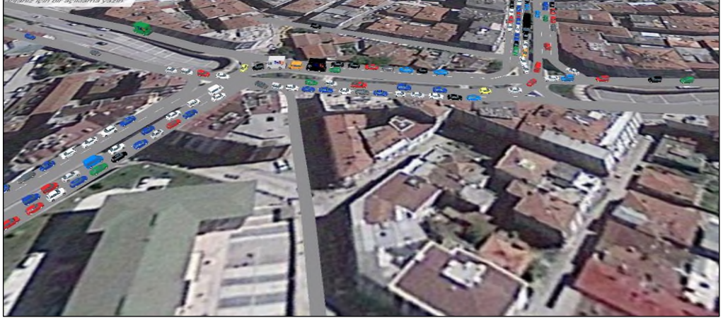
Şekil 5.10. Vissim Modelinde Mevcut Durumdaki Yoğunluk
