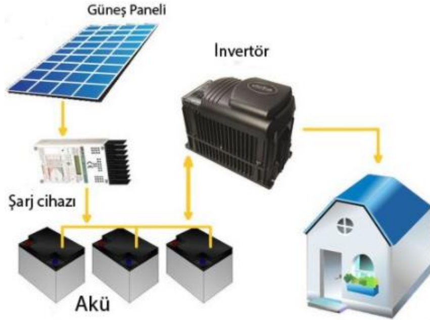
Şekil 3.35. Şebekeden Bağımsız Fotovoltaik Enerji Sistemi Bileşenleri (Mühendistan, 2020)
