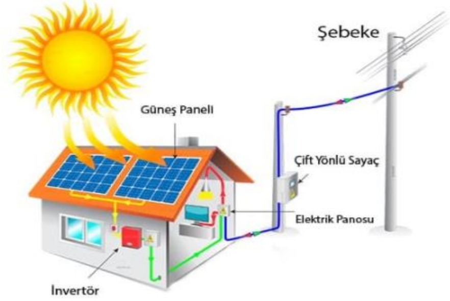
Şekil 3.36. Şebekeye Bağlı Fotovoltaik Enerji Sistemi Kurulumu (Elektrikde, 2020)
