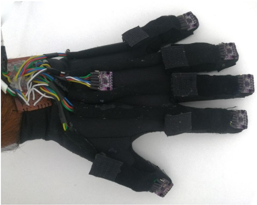
Şekil 3.28. Sensörler yerleştirildikten sonraki eldiven şekli
