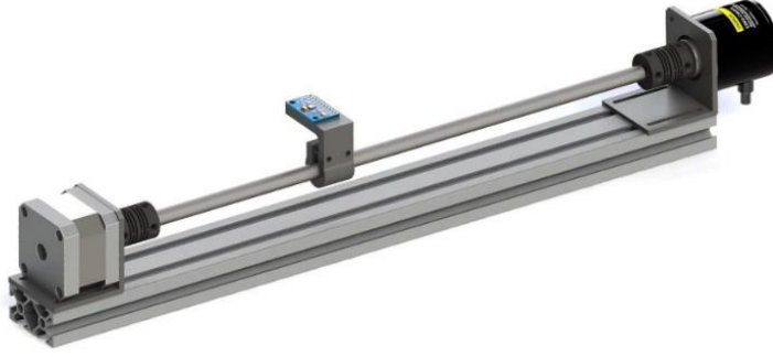
Şekil 3.9. IMU deney test düzeneği CAD tasarımı
