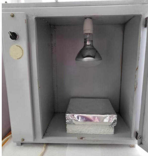
Şekil 4.1. UV ışık kaynağı olarak kullanılan reaktör
