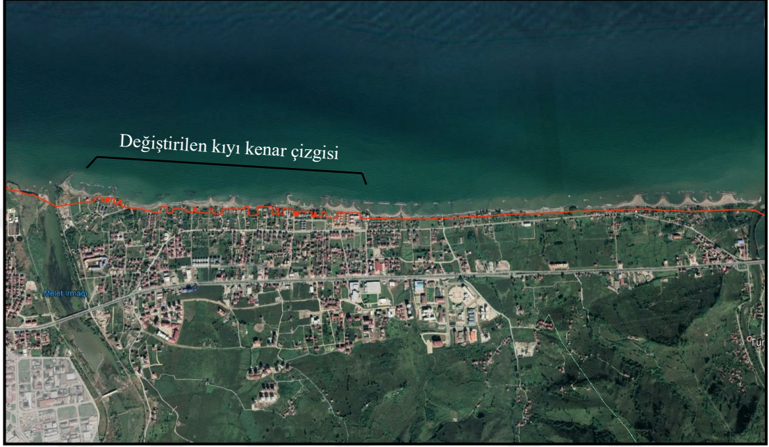
Şekil 6.5. Melet Çayı ile Turnasuyu Çayı arasında kalan kıyı bölümünde değiştirilen kıyı çizgisi
