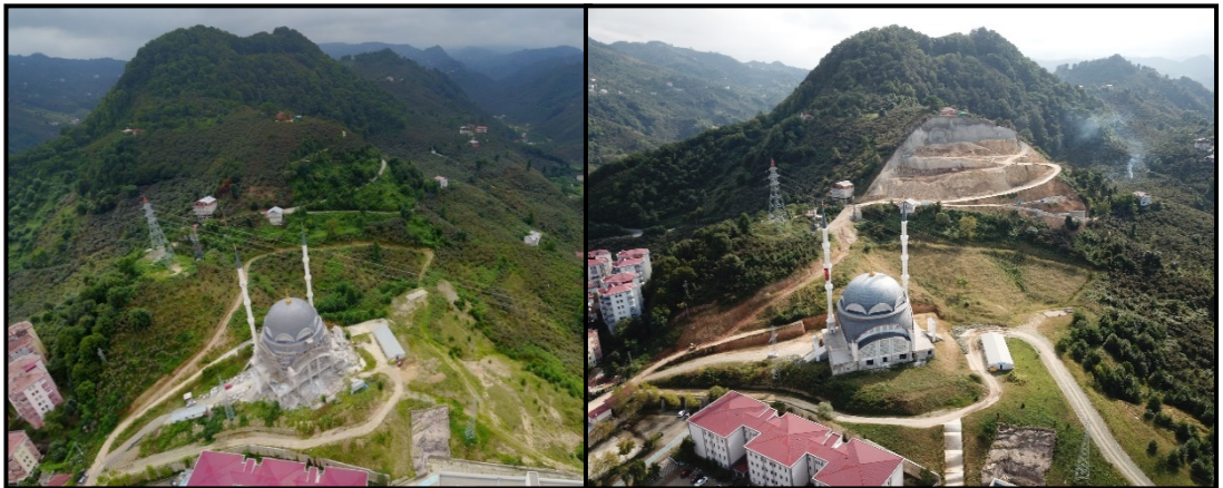
Şekil 5.24. Yamaçlarda kazıcı faaliyetlerle konut sahaları için alan temini (Güre Mahallesi/Giresun)
