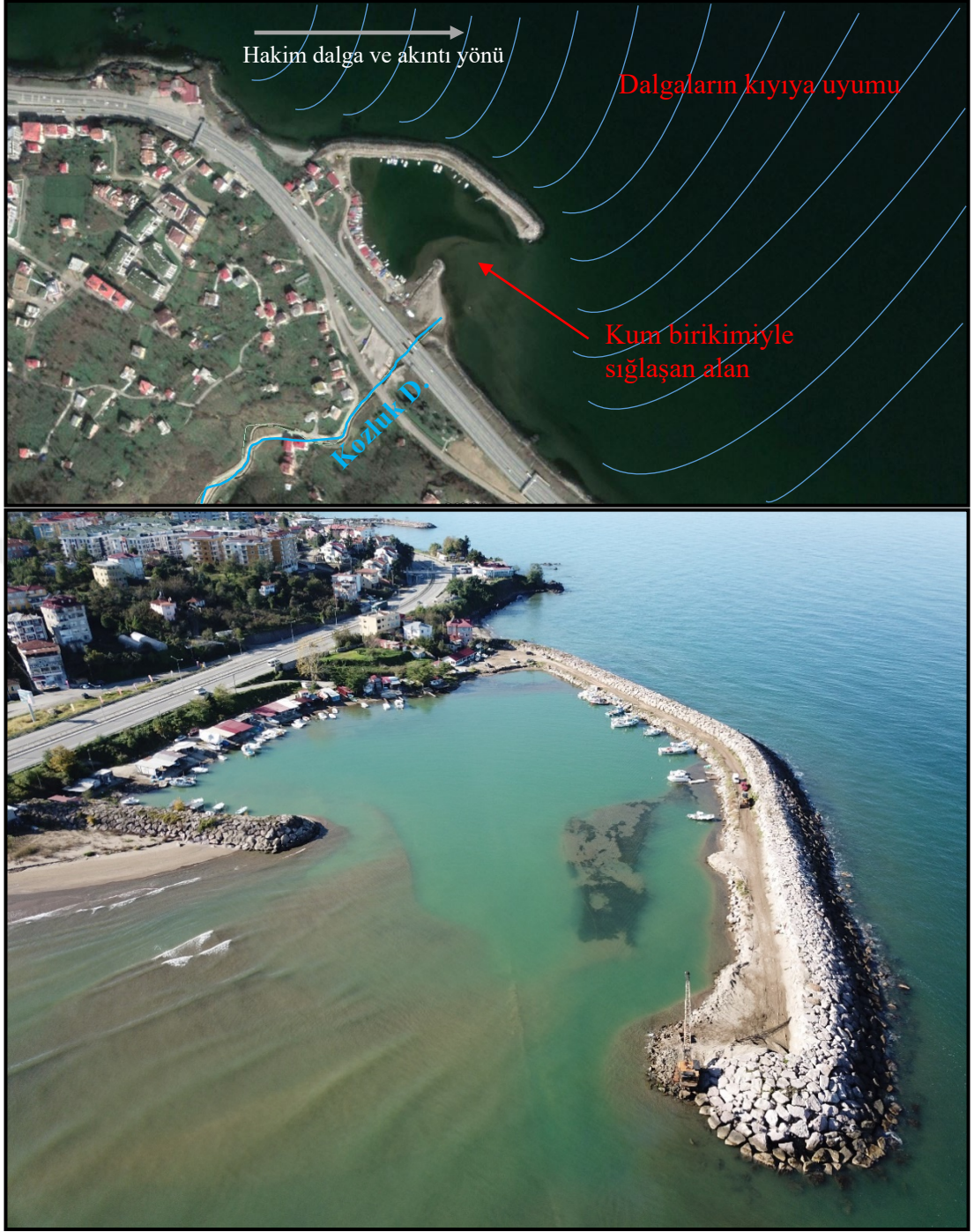
Şekil 5.8. Balıkçı barınaklarının kum birikimine bağlı olarak sığlaşması/Yalıköy çekek yeri (28 Ekim 2018)
