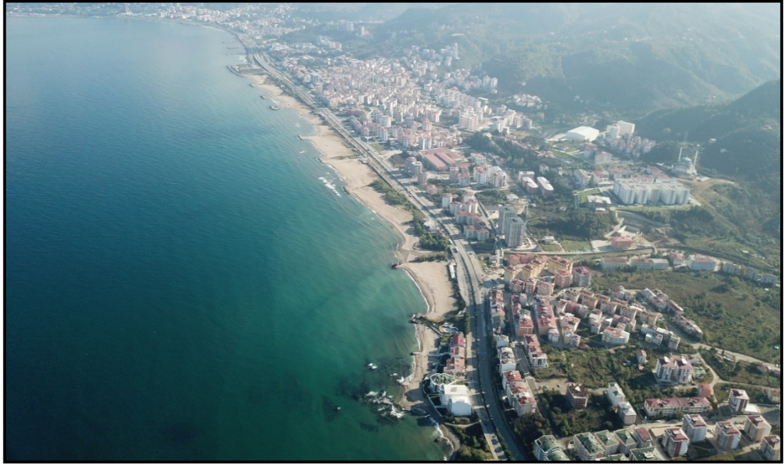
Şekil 2.44. “T” şekilli mahmuzların aralarının dolmasıyla gelişen plajlar (Güre Mevki/Giresun-7 Kasım 2018)
