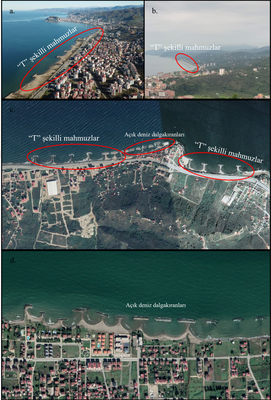
Şekil 5.12. Dalga ve akıntılarının erozyonel etkilerini önlemek amacıyla ön kıyıya yapılan “T” şekilli mahmuzlar ve açık deniz dalgakıranları, a. Teyyaredüzü Mahallesi (Giresun), b. Keşap, c. Piraziz, d. Cumhuriyet Mahallesi (Altınordu)
