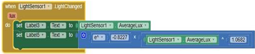
Şekil 4.4. Akıllı telefon ile güneş radyasyonu ölçümü için MIT App Inventor ortamında oluşturulan mobil uygulamaya ait blok şeması
