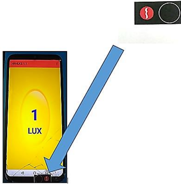
Şekil 3.6. Akıllı telefonun ışık sensörünün üzerine difüzörün yerleştirilmesi
