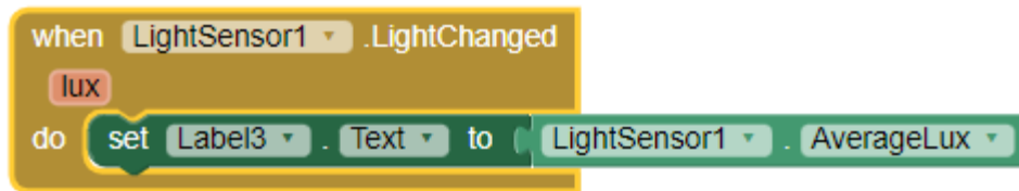
Şekil 3.4. Aydınlanma şiddeti ölçümü için MIT App Inventor ortamında oluşturulan mobil uygulamanın blok şeması
