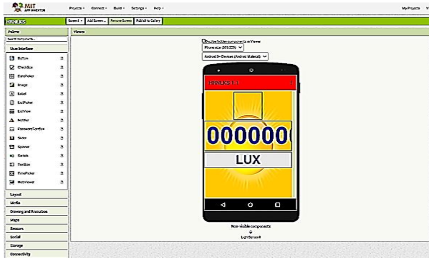
Şekil 3.3. MIT App Inventor ortamında aydınlanma şiddeti ölçümü için mobil uygulama oluşturulması
