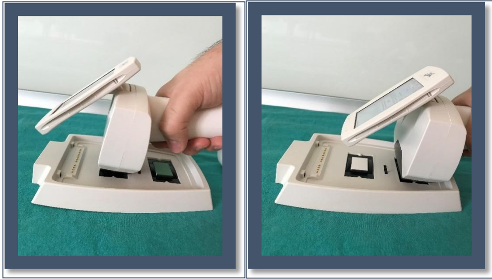
Şekil 3-8 Ölçüm işlemleri öncesinde cihazın kalibrasyonunun yapılması (Beyaz-Yeşil Fon)
