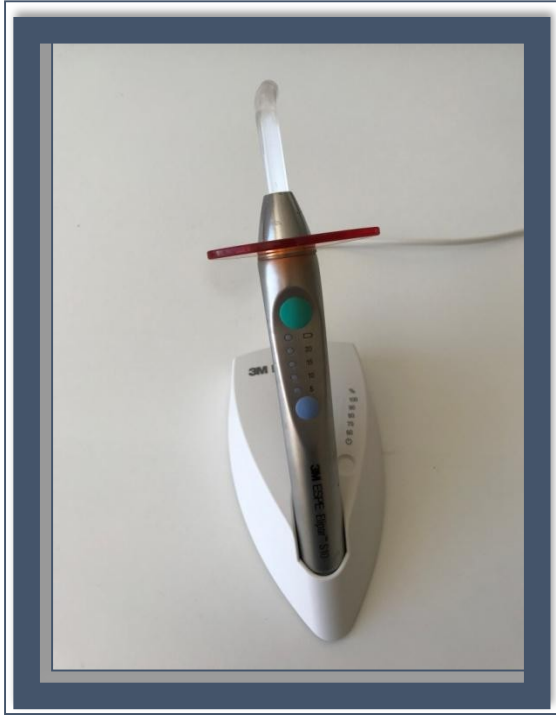
Şekil 3-3 Örneklerin polimerizasyonu için kullanılan Light-Emitting Diode (LED) ışık cihazı
