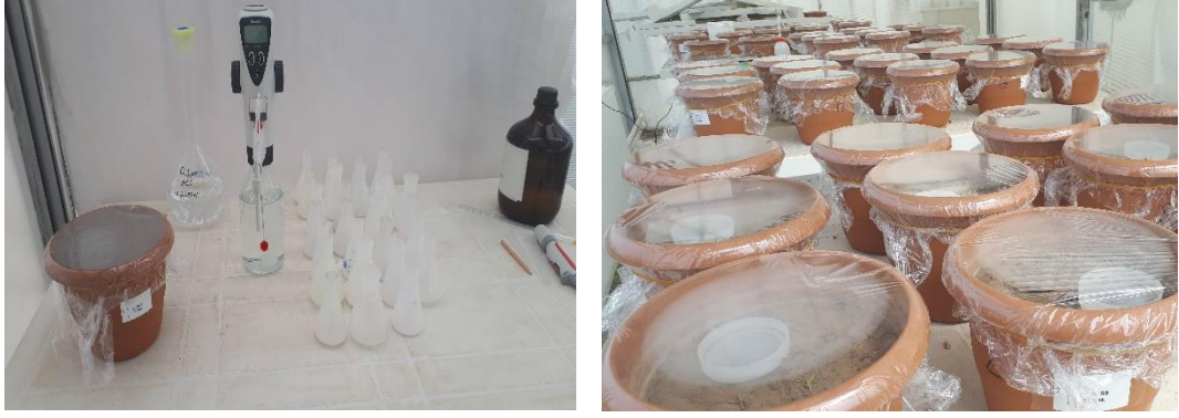
Şekil 3.4. Sera koşullarında toprakların CO 2 üretimi belirlenmesi
