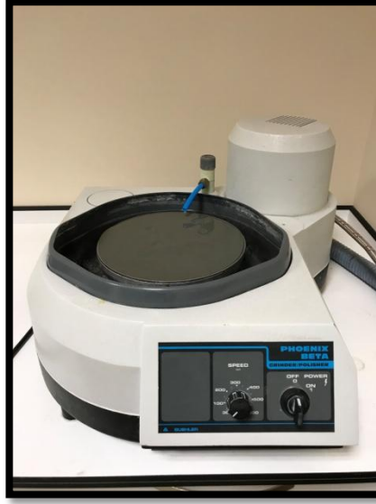
Şekil 10. Örneklerin polisajı için kullanılan cihaz (Phoenix Beta Grinder and Polisher, Buehler, Almanya)
