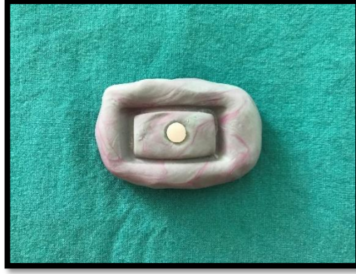
Şekil 16. Kullanılan silikon renk ölçüm platformuna yerleştirilmiş bir örnek
