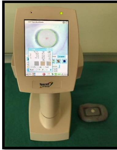
Şekil 19. Renk ölçüm değerlerinin cihaz üzerinde tespiti
