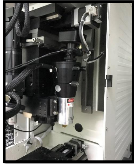
Şekil 13. Atomik Kuvvet Mikroskobu (Bruker Nano Surface Division AFM probes, Santa Barbara, CA, ABD)
