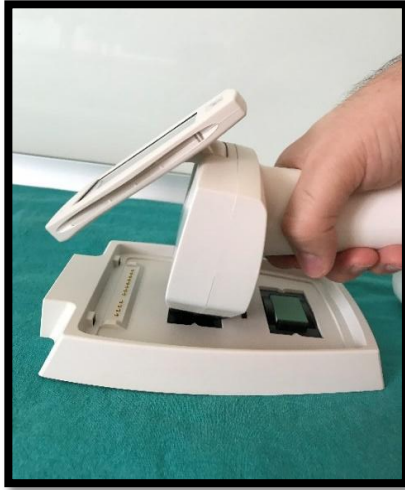
Şekil 17. Ölçüm işlemleri öncesinde cihazın kalibrasyonunun yapılması (Beyaz-Yeşil Fon)
