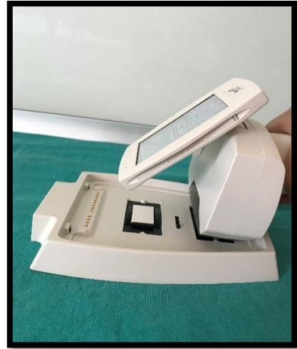
Şekil 17. Ölçüm işlemleri öncesinde cihazın kalibrasyonunun yapılması (Beyaz-Yeşil Fon)
