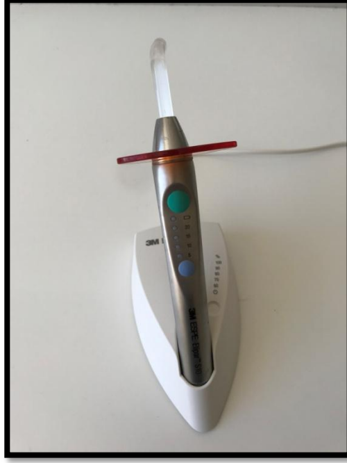
Şekil 9. Örneklerin polimerizasyonu için kullanılan Light-Emitting Diode (LED) ışık cihazı
