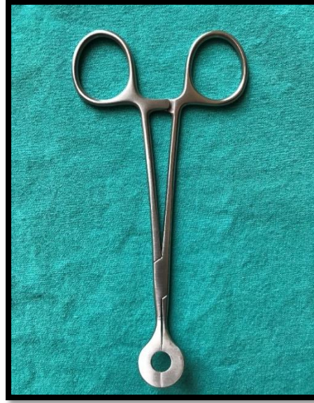
Şekil 8. Örnekleri hazırlamak için kullanılan paslanmaz çelik kalıp
