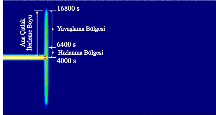
Şekil 6.23. Fiber açısı 90° olan referans durumun 16800. zaman adımında hasar ilerleme sonucu
