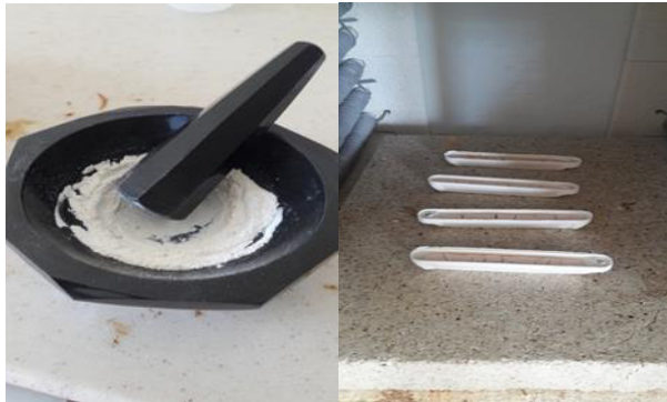
Şekil 5.1. SABS esaslı inorganik dolgu maddesinin üretim aşamaları. a) çözeltinin jelleşene dek karıştırılması, b) jel kısmın süzülmesi, c) süzülen tozun kurutulması, d) kurutulmuş tozun öğütülmesi, e) öğütülen tozun ısıl işlemi.
