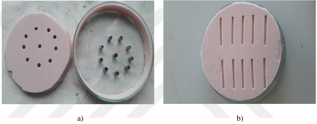
Şekil 5.3. a) Basma testi için ISO 4049 standartına uygun olarak çap 4mm ve yükseklik 6mm olmak üzere silindirik olarak hazırlanmış silikon kalıp b) Eğilme testi için ISO 4049 standartına uygun olarak 20mmx 2mmx 2mm ölçülerinde hazırlanmış silikon kalıp
