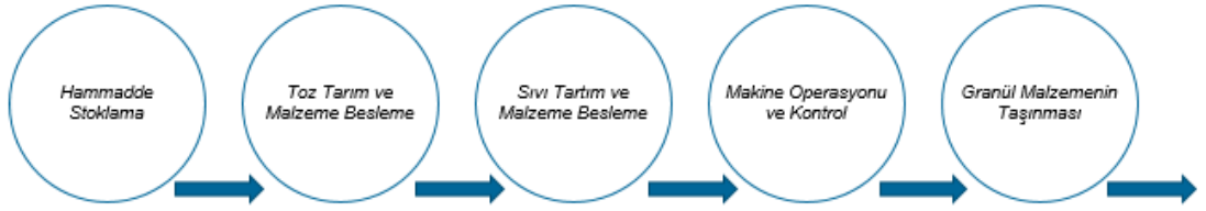
Şekil 3.4. Süreç akış şeması
