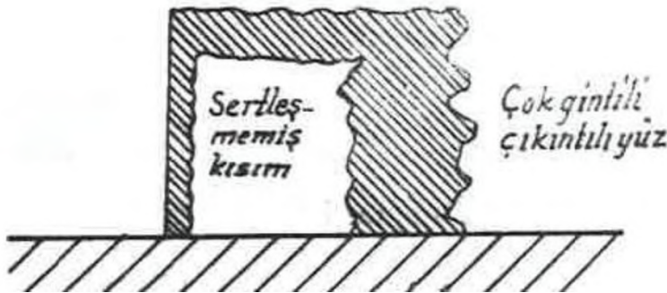
Şekil 3.4. Hava kireci kullanılarak yapılmış bir tür kalın sıvada kabul oluşumu ve sertleşmemiş kısım (Durmaz, 2019)
