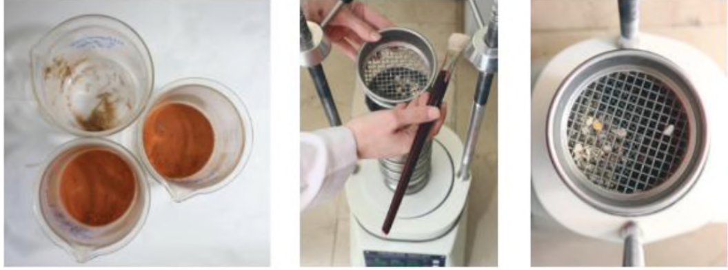
Şekil 4.2. Asit kaybı analizinden sonra kurutulmuş ve elenerek boyutlarına göre ayrılan örnekler (Alkan vd., 2009)
