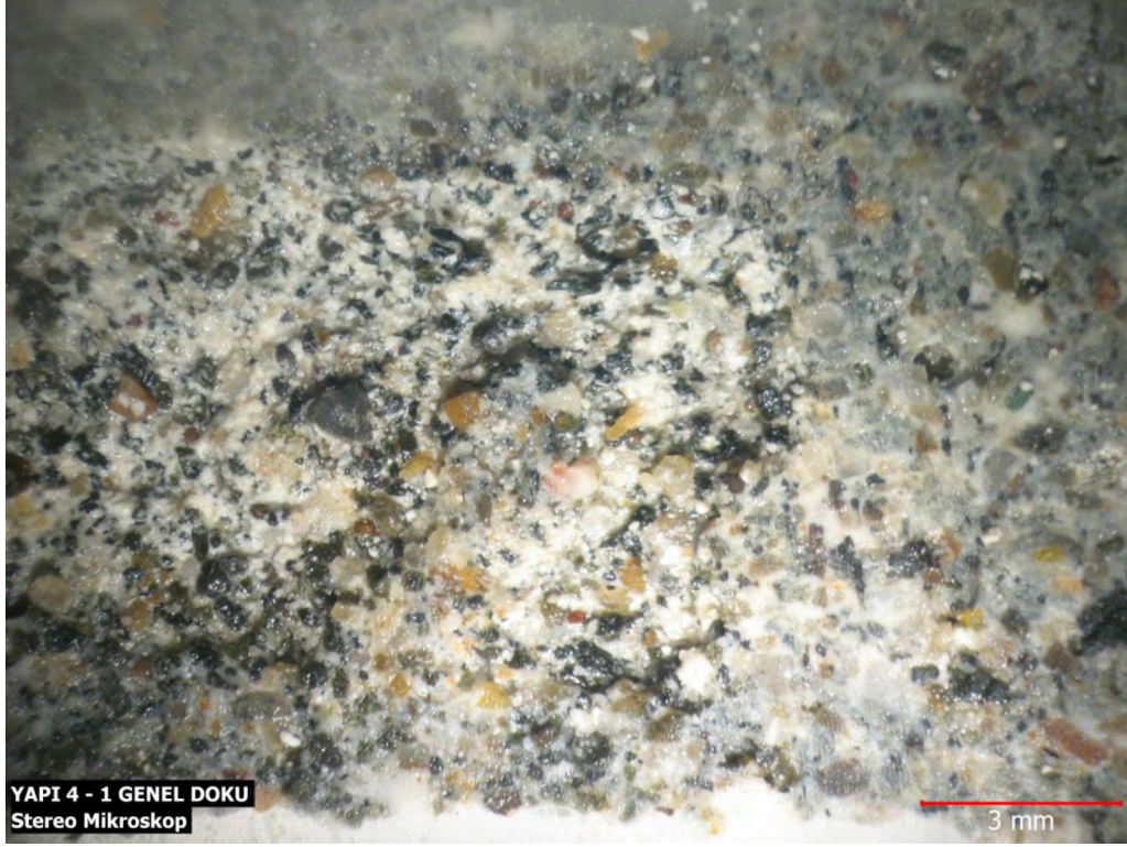
Şekil 6.16. Ordu Sivil Mimari Örneği-2'ye ait OSMÖİ-S numaralı örneğin mikroskop görüntüsü
