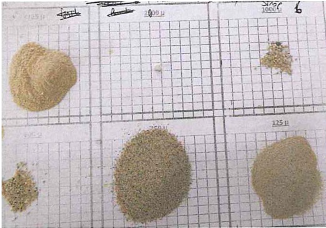
Şekil 6.139. SKD-H6 örneğinde agregaların görsel analizleri
