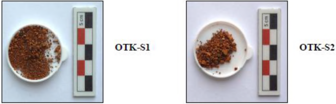
Şekil 6.8. Ordu Taşbaşı Kilisesi sıva örneklerinde asidik agrega/bağlayıcı analizi ile elde edilen agregalar
