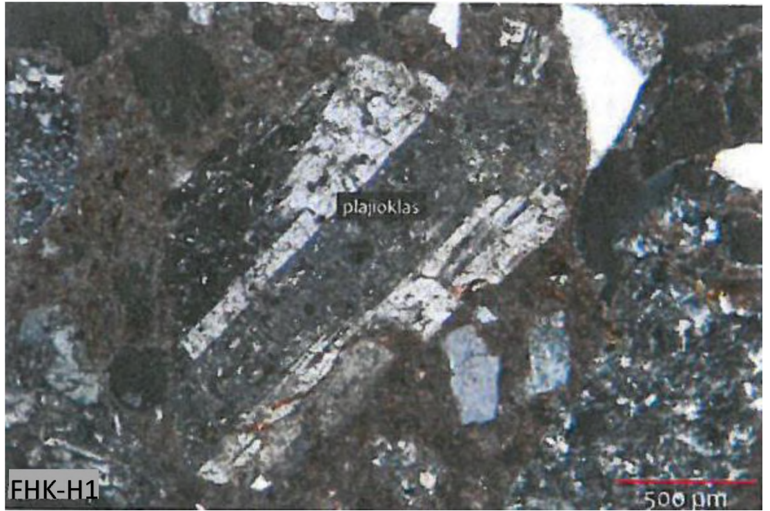
Şekil 6.30. Fatsa Hazinedarođlu Konađı'na ait FHK-H1 numaralı örneđi polarizan mikroskop görüntüsü
