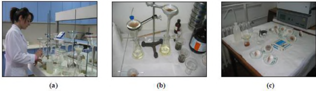
Şekil 6.7. Asidik agrega ve bağlayıcı analizi; (a) asidik işlem (%5 hcl), (b) süzme / yıkama ve (c) kurutma işlemleri (MAKLAB)
