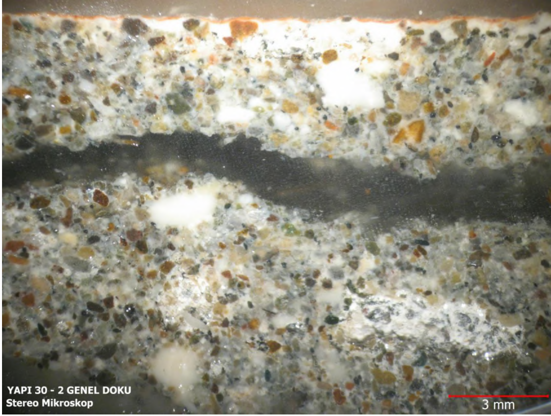
Şekil 6.13. Ordu Sivil Mimari Örneği-1, OSMÖB-2 numaralı örneğin mikroskop görüntüsü
