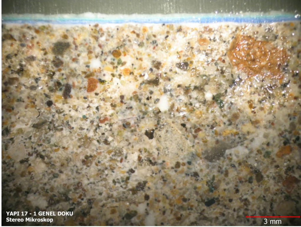
Şekil 6.24. Ordu Sivil Mimari Örneği-4'e ait OSMÖD numaralı örneğin mikroskop görüntüsü
