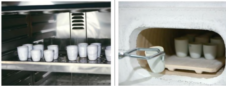
Şekil 4.4. Solda örneklerin 105 °C'deki etüvde kurutulması, sağda kül fırınında 550 °C ve 1050 °C'de bekletilmesi (Alkan vd., 2009)
