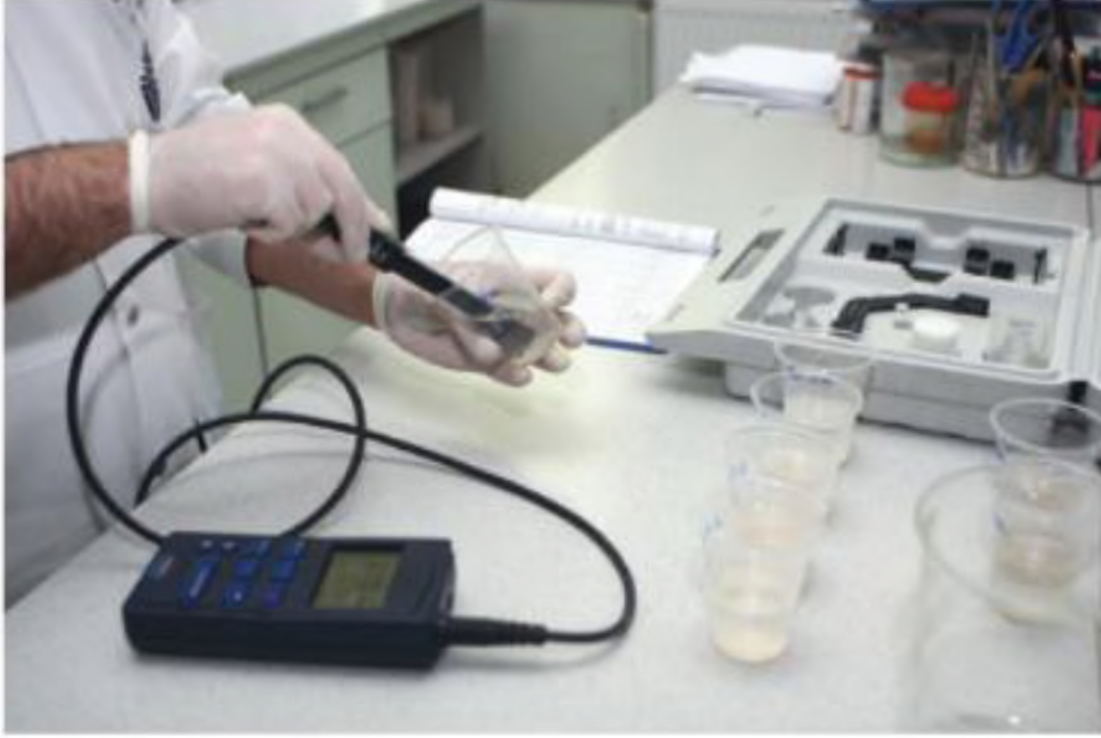
Şekil 4.3. İletkenlik ölçümü (Alkan vd., 2009)
