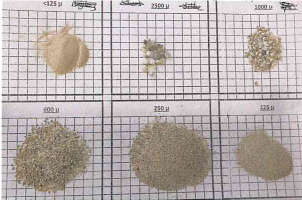
Şekil 6.151. STC-H1 örneğinde agregaların görsel analizleri
