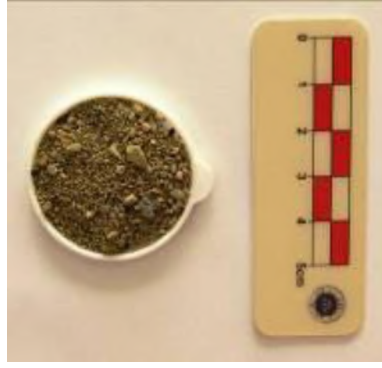
Şekil 6.103. Kavak Koca Köprü'ye ait örneklemeleri agregaları (asidik işlem sonrası elde edilen)
