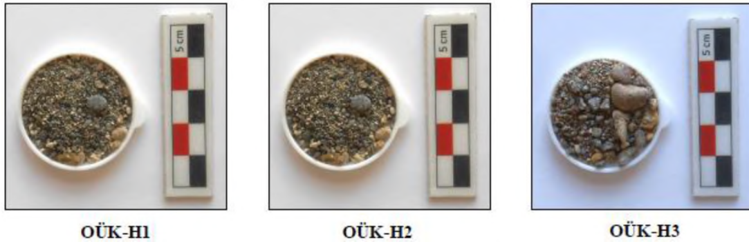
Şekil 6.36. Ünye Kalesi harç örneklerinde asidik agrega/bağlayıcı analizi ile elde edilen agregalar
