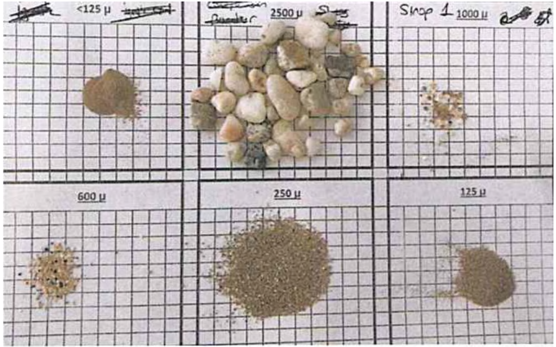
Şekil 6.134. SKD-H1 örneğinde agregaların görsel analizleri
