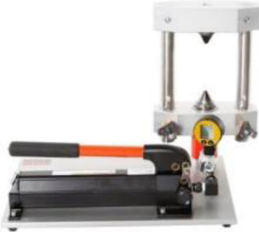
Şekil 4.17. Point-load deney aleti (Wille Geoteknik, 2020)
