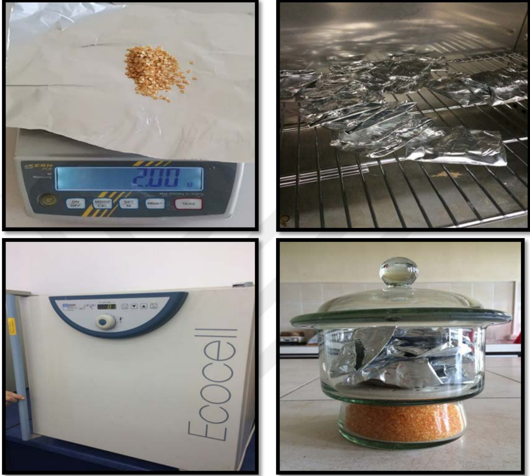
Şekil 3.5. Capsicum chinense genotiplerinde tohum nem testinin yapıış aşamaları
