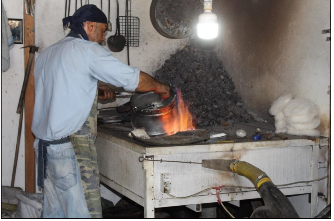
Şekil 3.13. Bakırcı ustasının kalaylama işleminden görünüm
