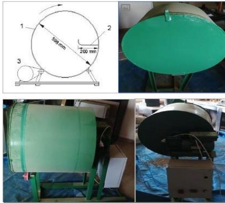
Şekil 3. 5 Mekanik dayanıklılık test düzeneği
