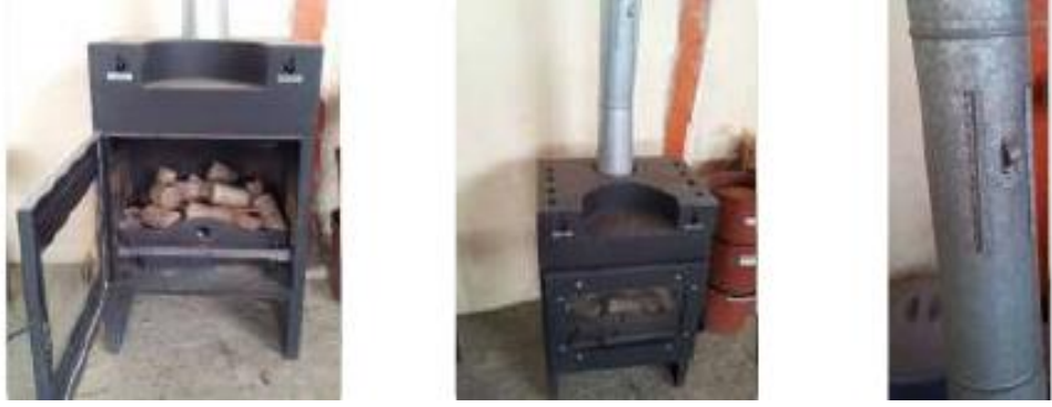
Şekil 3. 8 Briketlerin yakılması için kullanılan şömine tipi soba
