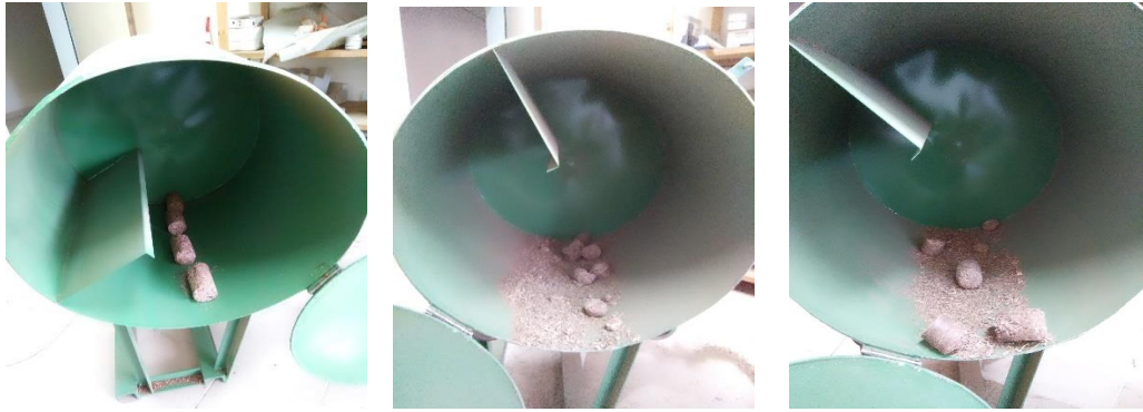
Şekil 3.15. Dayanıklılık (tumbler) test düzeneği
