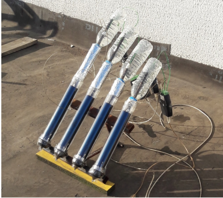
Şekil 3. 1. Yer Çekimi Destekli Isı Borusunda Bulunan Adyabatik Bölge Uzunluğunun Isı Borusu
