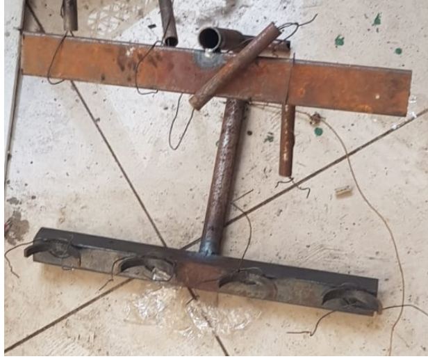
Şekil 3. 4. 41^\circ Eğimde Isı Borularına Yerleştirmek İçin
