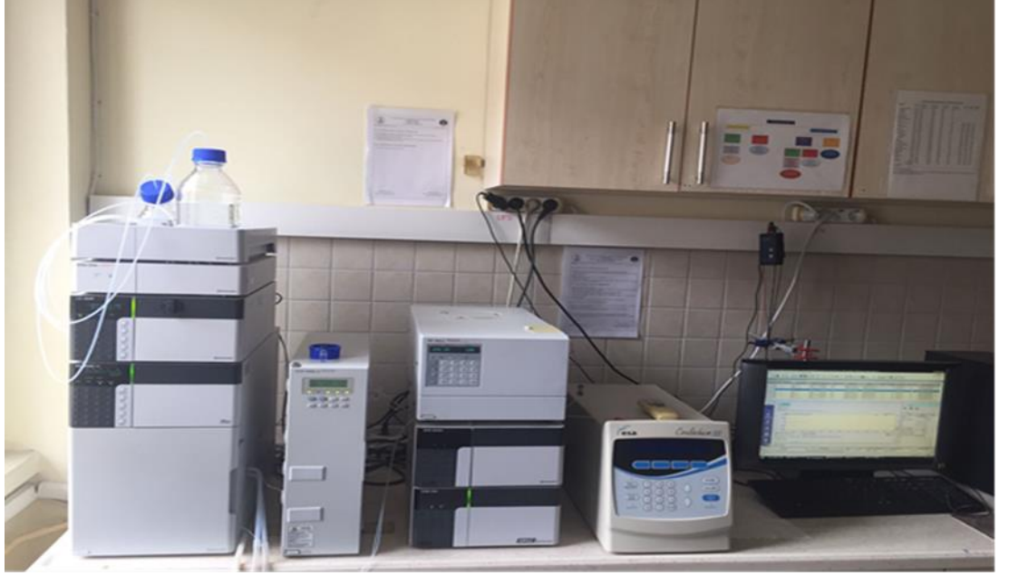
Şekil 3.6. Örneklerin BPA analizinde kullanılan HPLC
