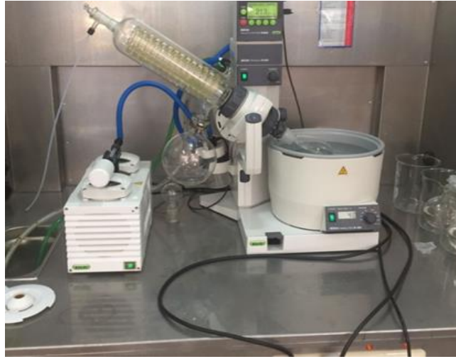
Şekil 3.3. Yağlı örneklerden elde edilen asetonitril fazının rotary evaporatör ile uzaklaştırılması
