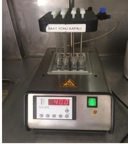
Şekil 3.4. Eluatın azot gazı altında uçurulma işlemi
