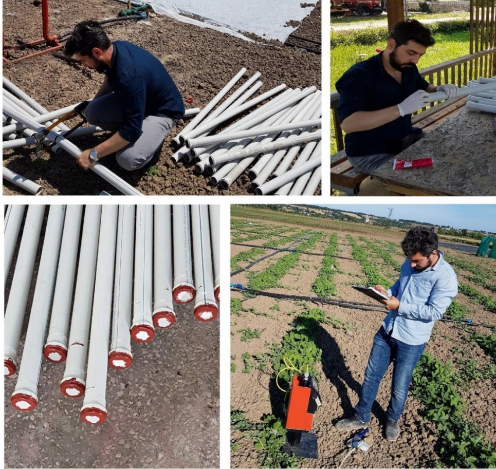
Şekil 3. 12. Akses tüpü ve nötronmetre okuması
