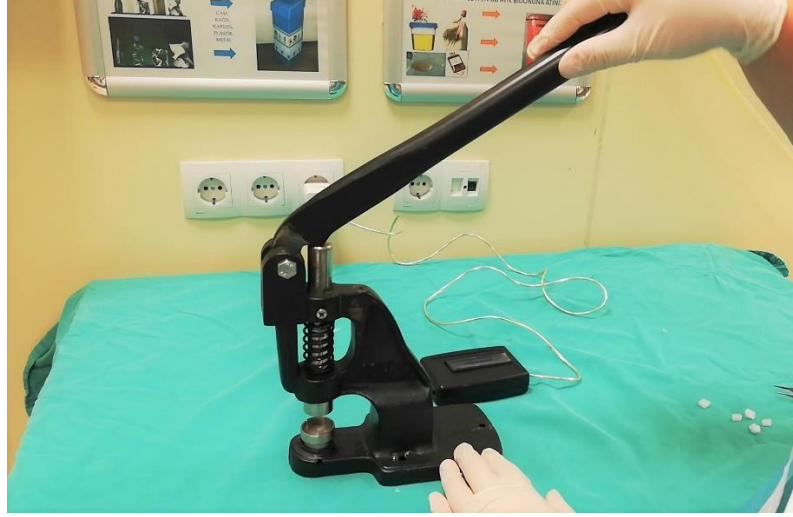
Şekil 4 : Ölçülebilir kuvvetleri uygulayabilen doku presi
