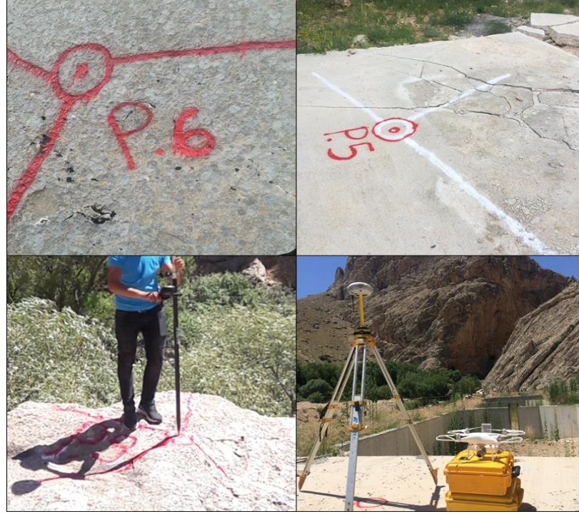
Şekil 4.6. RTK (CHC X91 GNSS) sabit ve gezici cihazları ve yer kontrol noktalarının arazideki işaretlemeleri
