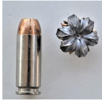
Őekil 2.6. HP merminin deformatsyonu (Roberts, 2019)
